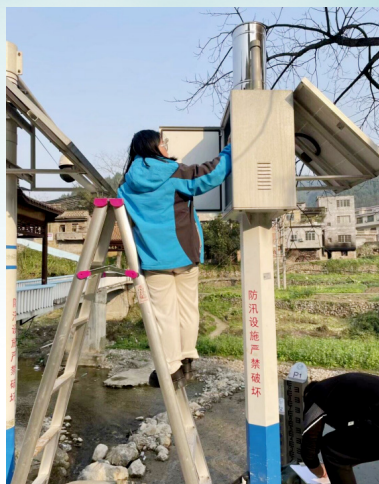
泸州水文中心石雪维护遥测雨量器
