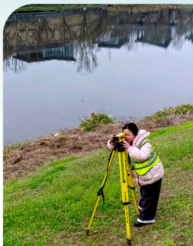
自贡水文中心杨念在自贡水文站校测水准点
